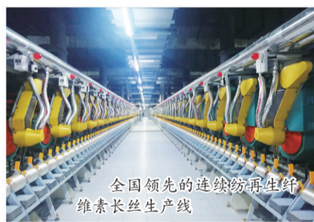
全国领先的连续纺再生纤维素长丝生产线
