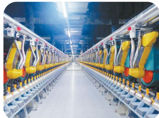
连续纺再生纤维素长丝生产线
