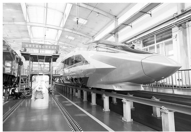
这是在铁科院国家铁道试验中心接受试验验证的CR450动车组样车(2月25日摄)。近日，运营时速400公里的高铁列车CR450动车组样车在北京发布。目前相关团队正在开展一系列科学试验和性能验证，为动车投入商业运营创造条件。
