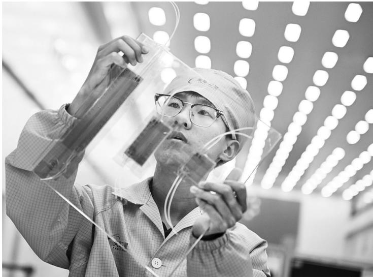
四月二十一日,天章卫星工作人员在组装卫星前进行加热片粘贴练习。入驻鹤壁市卫星智造产业园的企业天章卫星,成功获批卫星制造基地。近年来,河南省大力发展商业航天产业,推动建设卫星条卫星产业集群,做强卫星制造配套产业,鼓励各地差异化发展卫星应用产业。
