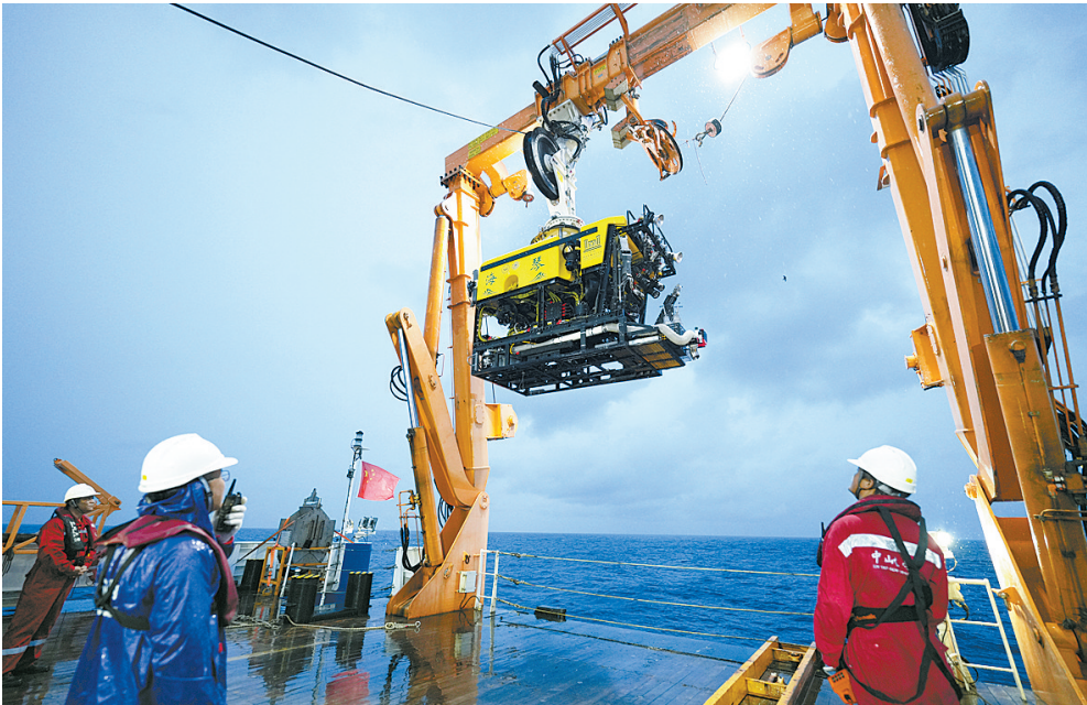
8月23日清晨拍摄的“海琴”号从海里回收时的情景。 8月23日清晨，在南海的晨曦中，我国自主研发的6000米级深海无人遥控潜水器（ROV）“海琴”号，经过8个小时作业，从4140米深海凯旋，成功进行海试，我国深海研究又多了一个“科考利器”。 “海琴”号搭载了高清摄像机、多功能机械手等科考设备，具备自动定向、悬停定位、自动巡线等智能作业能力。 新华社记者 张建松 摄
