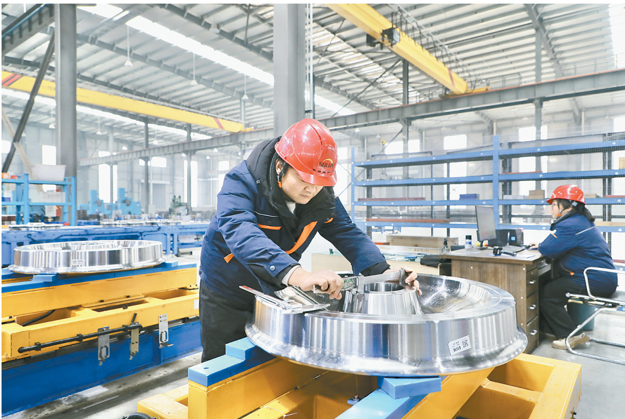
12月11日,河南速轮轨道交通装备有限公司车间内,工人正在检测产品直径。该项目以高端连铸圆坯为原料,专业生产直径400mm—1250mm的大型火车轮与工业车轮,产品应用于轨道交通及重型工业领域。当前,我市正全力拼经济、抓招商,以项目落地提速冲刺全年发展目标。
