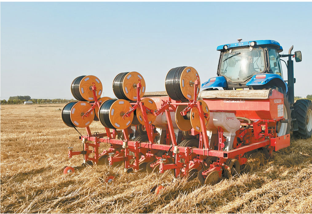
六月九日,获嘉县弘盛农机专业合作社运用北斗导航一体化播种技术,同步完成播种、施肥、镇压、作业,为秋粮丰产筑牢保障。新乡日报全媒体记者 赵云撰
