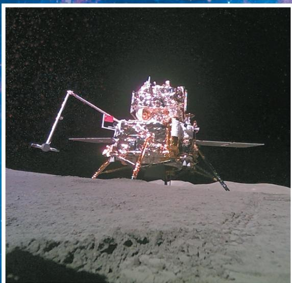
嫦娥六号携带的“移动相机”自主移动后拍摄并回传的着陆器和上升器合影
